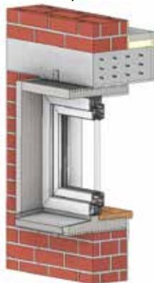
Monolithique avec système de caisson de volet roulant RA-RS
