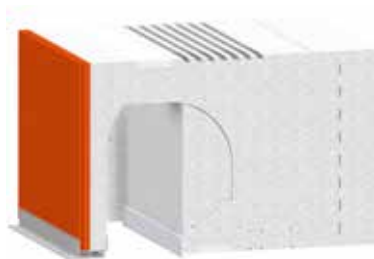
Raffstore Befestigung nach oben
