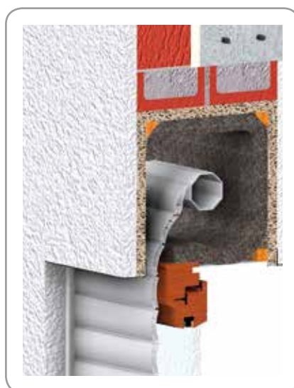
Selbstklebendes, flexibles Grupor® Rollladenkasten-Sanierungssystem
